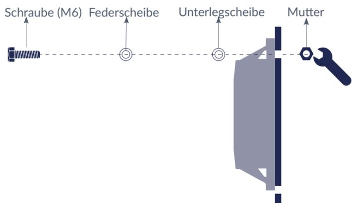
1. Verwenden Sie Schrauben der geeigneten Größe; es wird empfohlen, Schrauben vom Typ M6 zu verwenden und an den Schrauben Gewindesicherungskleber anzubringen. Wir empfehlen Loctite Thread Locker Blue 242.
